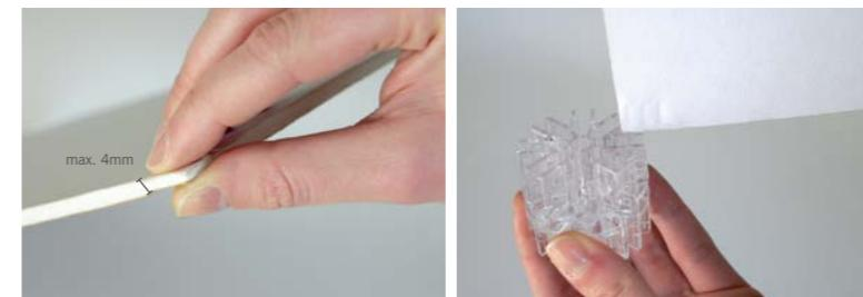
particolarmente indicato per pannelli leggeri flessibili e non troppo rigidi o per cartone di 5 mm di spessore, ma che si possano ridurre a 4 mm durante l'insertiono in digiplug.
