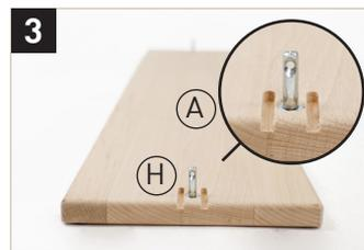
**(H) Schritt 1-3 WICHTIGER HINWEIS:** Schrauben Sie Halter H bis zum Anschlag manuell ein (nicht zu fest). Drehen Sie dann Halter H soweit wieder auf bis das Loch parallel mit Länge von Fuß A ist (Abb. 3). Halter H wird etwas locker sitzen, dies ist richtig und wird später durch Eindrehen von Teil G mit Schritt 6 fest verbunden.
