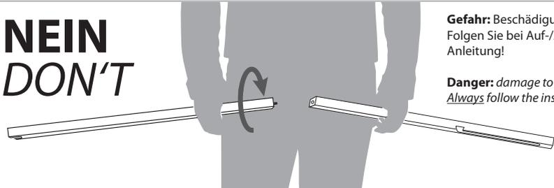
**Gefahr:** Beschädigung der Gewinde
