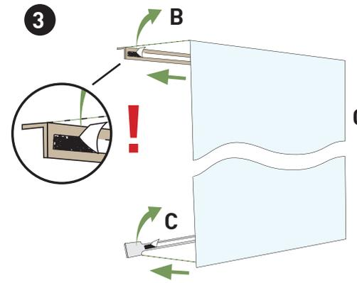
Folie auf Klebestreifen abziehen und Rückseite des Banners an Leisten kleben. Achten Sie auf korrekte Position von Leiste B zum Banner!
